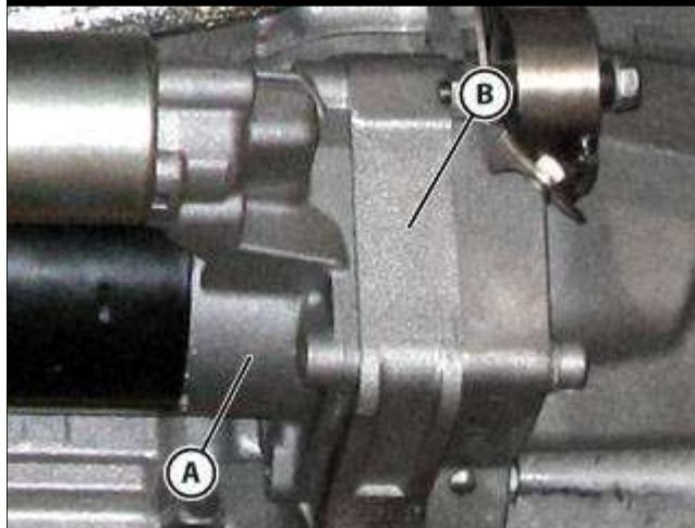
● 确保起动机 (A) 与下部曲轴箱壳体 (B) 上相应的配合面正确接触。
