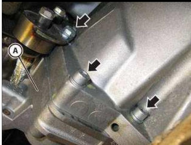
● 用手拧紧指示的用于将起动机 (A) 紧固至下部曲轴箱壳体的螺钉。
