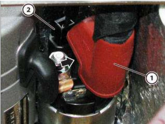
● 在原始位置重新安装，连接发动机供电电缆，拧紧相应的螺母，然后安装护盖 (1)。
